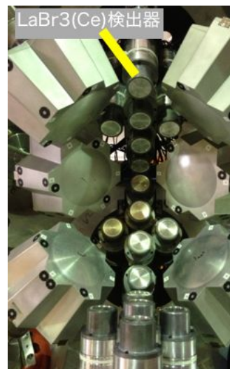
図2: 高速タイミングアレイ( \text{LaBr}_3(\text{Ce}) 検出器群、イギリスブライトン大、サリー大所有)。励起状態の寿命測定用。約1nsecの寿命測定に最適である。左右に見えるクラスター検出器に挟まれているのが \text{LaBr}_3(\text{Ce}) 検出器である。
