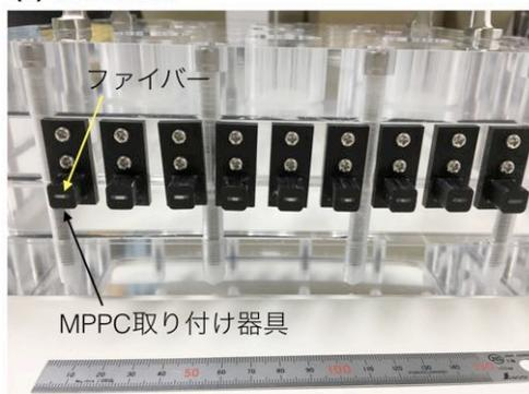
次に、上図の様に専用の固定器具を開発し、アクリルボックスの側面にネジ止めすることでファイバーを固定した。この固定器具の開発により、適度な張力をかけて固定し、なおかつ読み出し素子として使用する MPPC
