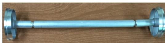
図5. 二重連結領域実験用中心電極
