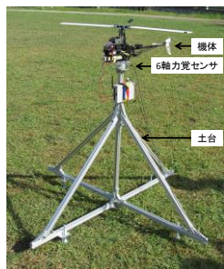
図4 力・モーメント計測地上試験装置
