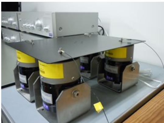
図3 . 4台の加振器で支持される平板
