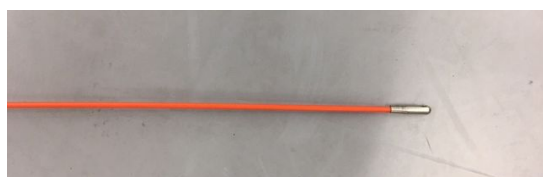
図4 挿抜試験に用いた内径 15 mm長さ 15m のコルゲートチューブとケーブル挿入用グラスファイバ
