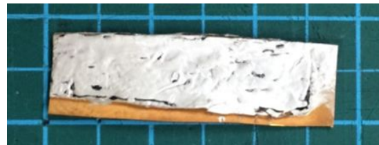
図6 PTC-SMP 一体型 IPMC の試作例
