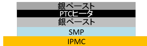
図5 PTC-SMP 一体型 IPMC の構造
