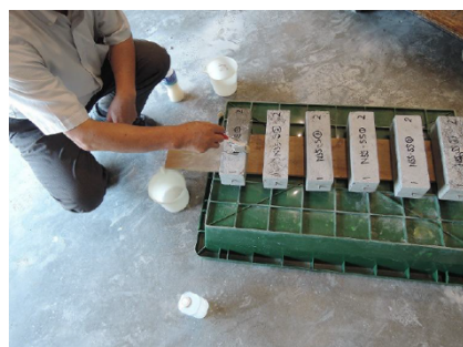
写真-1 表面含浸材塗布状況
