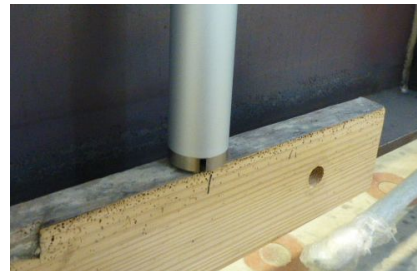
写真2 ピロディンによる計測の様子
