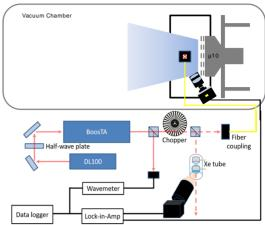
上図に示すように、レーザー誘起蛍光法によるイオン旋回流速度測定を行う.外部共振器レーザーから出た光は複数に分岐され、真空チャンバには光ファイバフィードスルーを通じて内部に導入される.真空チャンバでは測定対象のスラスタが設置されており、レーザー光をプルームに照射する.以下の原理によって速度は求められる.
