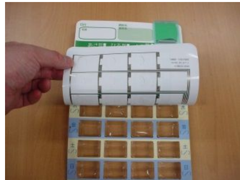
図 1 開封センサと通信モジュールを搭載したドーズパック
