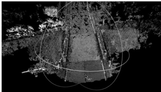
図 14. 市販コンパクトデジカメで地上撮影した多視点画像から生成した橋梁 3D モデル
