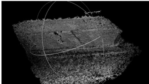
図 15. 市販コンパクトデジカメで地上近接撮影した画像から生成した橋梁のコンクリートはく離部および鉄筋露出部の 3D モデル
