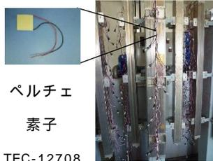
写真 1-1 試作した ZEPG の外観
