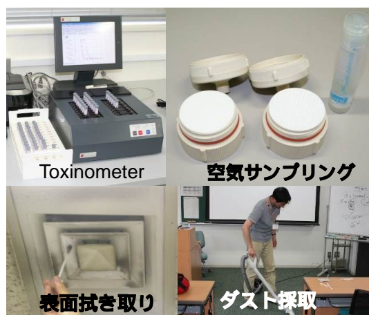
図 3 トキシノメータ - 及び現場測定例
