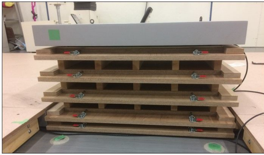
写真1. 課題2においてフォースプラットフォームの高さ調整に用いた台
