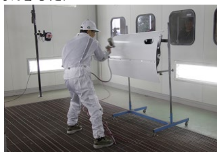
図4 塗装作業の測定の様子
