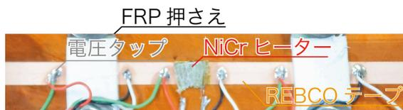
図 2. NiCr ヒーター付き超伝導線材の光学像。
