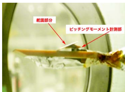
図6 舵面前方での放電気流制御実験模型
