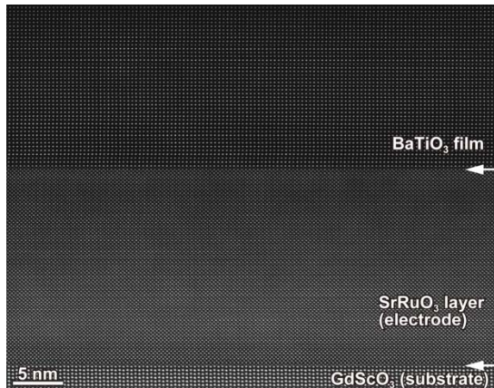
図2 BaTiO 3 薄膜の HAADF STEM 像。図中の矢印は BaTiO 3 薄膜と SrRuO 3 電極界面および SrRuO 3 電極と GdScO 3 基板界面を示す。
