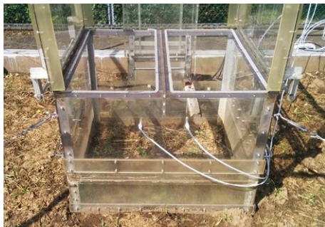
図2： N_2O 放出測定のためのチャンバーシステム。チャンバーは測定時に自動で蓋が閉じ、分析機器の設置している実験室内にガスが吸引される。測定は1日6回行った。
