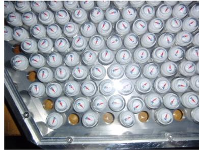
写真 「対称性の自発的破れ」の演示模型：磁石で外乱を与えたあと緩和を待つと磁区構造(右)ができる。
