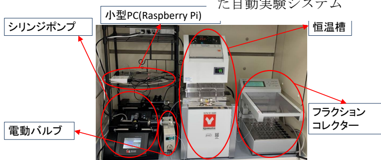
図2 鈴木・宮浦カップリング反応用に構成した自動実験システム
