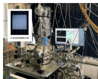
図 5 新たに製作したレーザー加熱 hBN 気相成長装置
