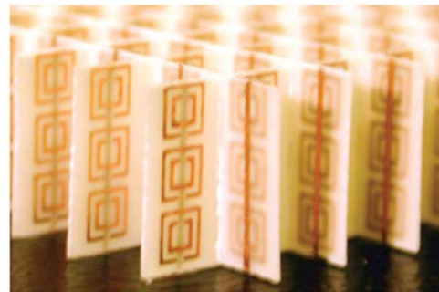
図 2 分割リングと金属細線を組み合わせた最初のメタマテリアル(D. R. Smith らによる)
