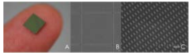
図6 試作テラヘルツ・光波領域メタマテリアル
