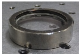
写真 2. 35 mm 上面がガラスでできた 35 mm ディッシュのふた。 重りも兼ねる。（トッケン社製）
