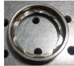
写真 2. 35 mm 上面がガラスでできた 35 mm ディッシュのふた。 重りも兼ねる。（トッケン社製）
