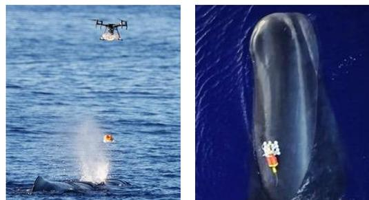
図5：ドローンによる投下(左)と吸着したローバー(右)
