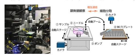
自動で行うロボット「ALPS」を開発した(上図)。その有用性は**岡崎班**と共同でT細胞の1細胞計測・解析にて実証し、計10報の論文発表と2件の特許出願を行った。本装置とAMATERASはシステム統合を進めている。
