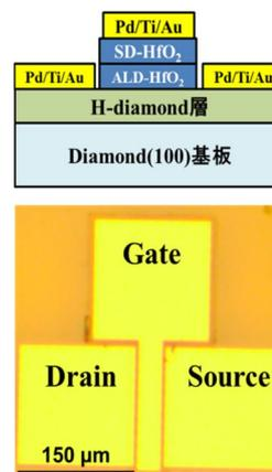
図4. ダイヤモンド/HfO<sub>2</sub>接合トランジスタ概略図およびフォト
