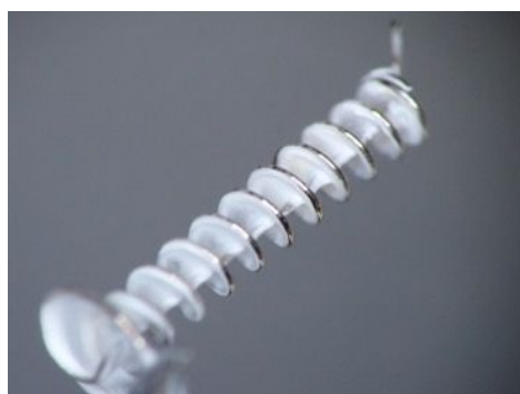
図 4 ヘリコイド状枠を用いた TiO 2 ナノコンポジット極小曲面の作成
