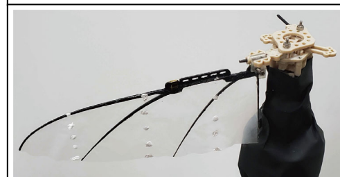
図3 3Dプリント柔軟翼。翼長 80 mm。
