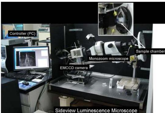
図 1 横置き型 EMCCD カメラ付き顕微鏡
