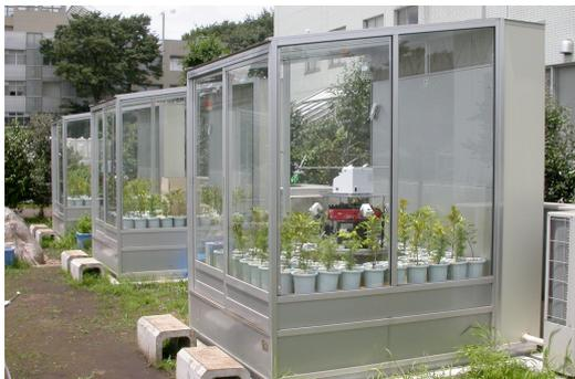
写真 1. 東京農工大学の府中キャンパスに設置したエアロゾル暴露チャンバー。チャンバー内の中央に粒子発生装置を設置し、その周囲に樹木を配置した。
