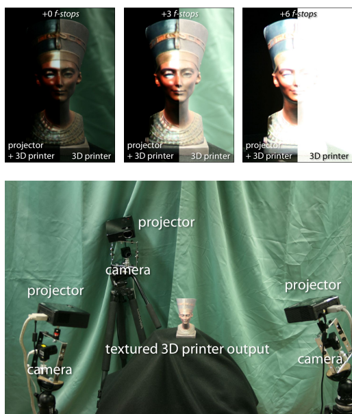
図4 カラー3次元プリンタから出力された模型に複数台のプロジェクタを使って映像を投影し、文化財を高いコントラストで再現した例(上段:映像を投影した場合としない場合でのコントラストを比較するため異なる露光時間で撮影した画像,下段:実験環境)。
