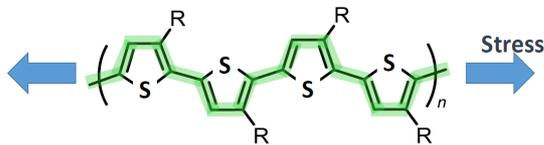
図2 ポリ(3-置換チオフェンの骨格構造)
