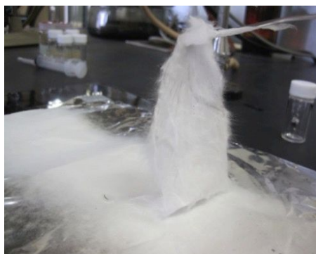
図5 エレクトロスピンング法で生成した不織布状のジルコニアナノ粒子分散ナノファイバー
