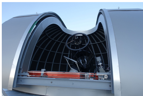
図5 中国・チベット・阿里サイトに設置された 50cm 広視野ロボット望遠鏡
