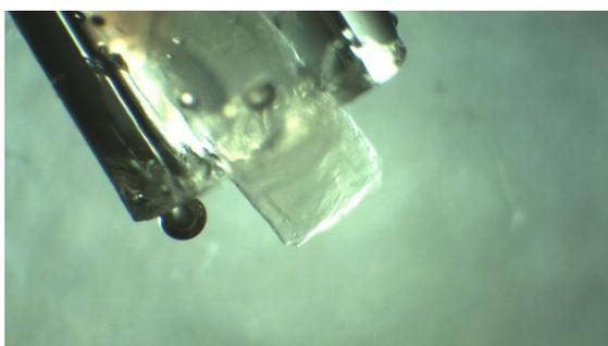
振動収縮によりガラスキャピラリーの中を移動するフェロイン型ゲルアクチュエータ
