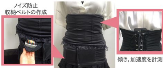
図6 Android 端末を用いたログシステム
