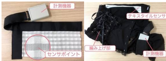
図5 左:テキスタイルセンサ、右:腹巻型圧力計測システム
