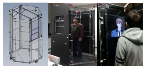
図 2 モバイルパーソナルスペースのスケルトン(左)壁を一部取り外した装置(中)および内部から外側を見た図(右)。
