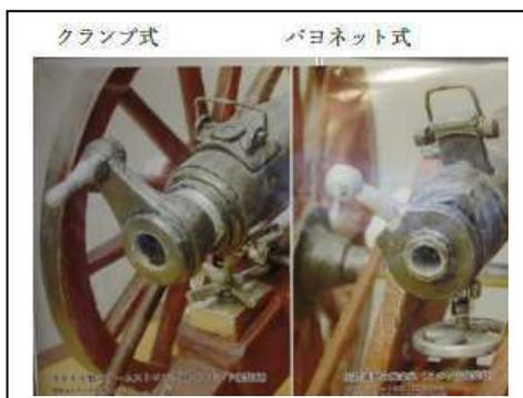
装執条砲弾) について蛍光X線および回折X線分析並びにICP-MS分析を行い、原料鉄の産地同定を試みた。鉄の存在量が前装砲弾では89.66であるのに対し、後装砲弾では55.62となっており、前装砲弾は明治前半制作の砲弾の96.99に近い。次に佐賀藩の上野の戦い絵図から佐賀藩製後装施条砲の尾栓部の構造がバーネット式でイギリスのランプ式よりも近代に近いアームストロング砲型の後装施条砲であったことを論述した（写真）。
