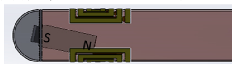
図4: 電磁走査型超音波内視鏡駆動原理
