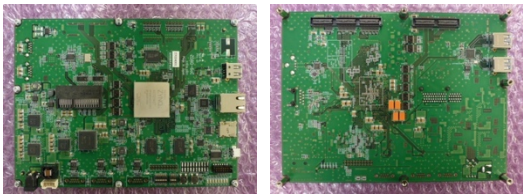
図4. 開発した System-on-Chip 集積回路を搭載した高速データ収集ボード。本ボードには、多様な I/F が搭載されており、汎用性が確保されている。
