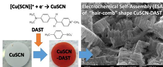
Fig. 3 CuSCN/DAST ハイブリッド薄膜の電気化学的自己組織化とナノ相互分離構造
