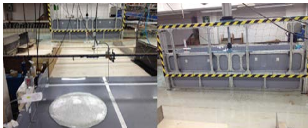
図-1 ゲート式段波装置と平面水槽実験の例
