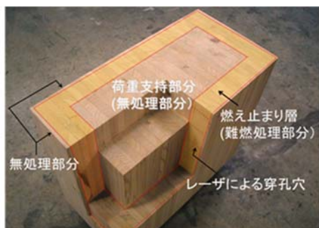
図1 耐火集成材の構成
