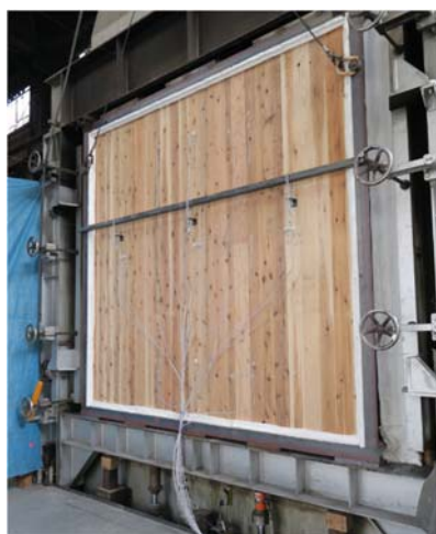
図 3 CLT 壁構造の実大加熱試験
