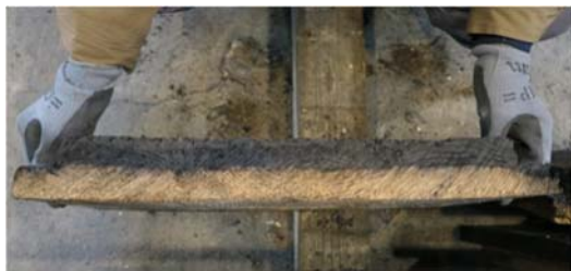
図 6 耐火試験後の難燃処理木質パネルの炭化状況
