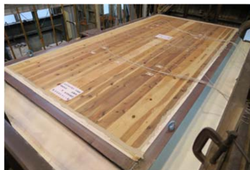
図 5 CLT 床構造の実大加熱試験
