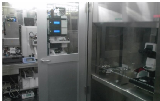
図1 本研究で設置したクリーンルームとクリーンベンチ及び超高分解能質量分析計
