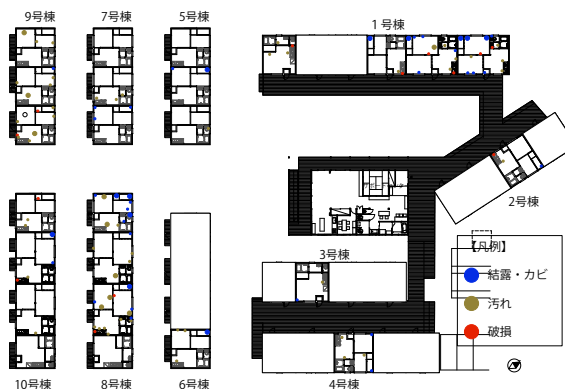
図 1 住戸内結露・汚れ・破損の状況
