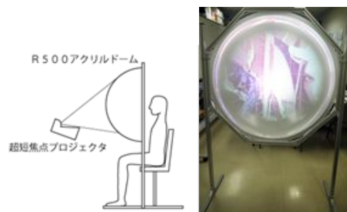
図7．シミュレータ試用環境1：直径1000mm リア投影ドーム環境(左)と投影状態(右)
