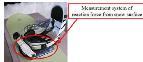
図1 雪面反力計測システム
