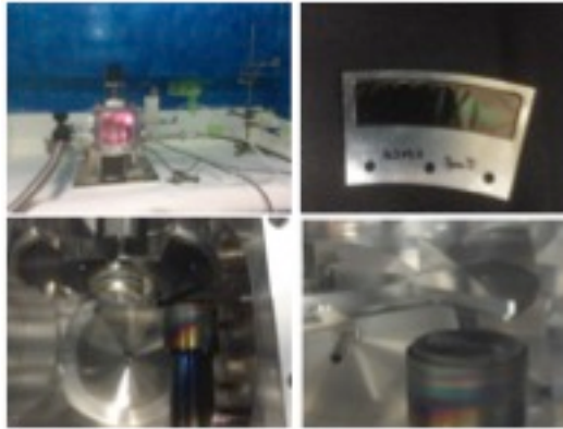
図③：アクチノイド標的( ^{238}\text{U} 専用)に製作した小型スパッタ装置。
